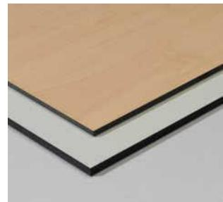
EGGER Laminát lakovatelný je laminát na bázi vytvrzovatelné pryskyřice bez dekorativního vzhledu. Je konstruovaný z více vrstev a skládá se z několika jádrových, fenolovou pryskyřicí impregnovaných vrstev, z lakovatelné přední strany a zadní strany přizpůsobené k lepení.
